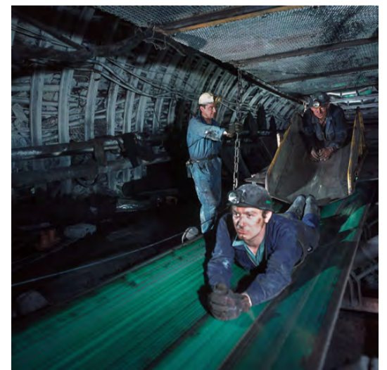
Transport du personnel par bande transporteuse. 1976 Ph. non indiqué. Reproduction 36 x 36 cm, d'après Ektachrome.
