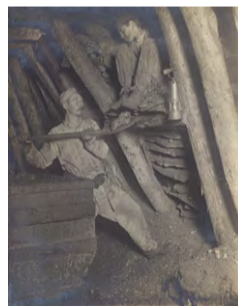
Compagnie des Mines de Carvin. Le chargement. Le charbon descend du chantier par des galeries dites cheminées ménagées dans les remblais. Un enfant de 13 à 14 ans le pousse dans ces cheminées, jusqu'à la voie de roulage, où le chargeur le reçoit dans sa berline. Octobre 1902. Ph. M. Corriol (ingénieur). Reproduction 42 x 32,9 cm, d'après un album de 33 photographies. 8,7 x 11 cm.
